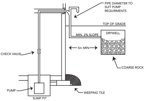
SUMP PUMP DISCHARGE TO DRYWELL
